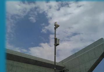
現場での監視強化として、気象観測ユニットの設置、監視カメラの設置を行っています。
