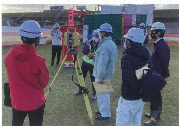
図-11 レーザースキャナーによる3次元測量の実演
