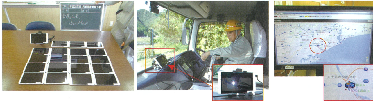
写真-20 工事車両運行管理システム【Vas Map】
